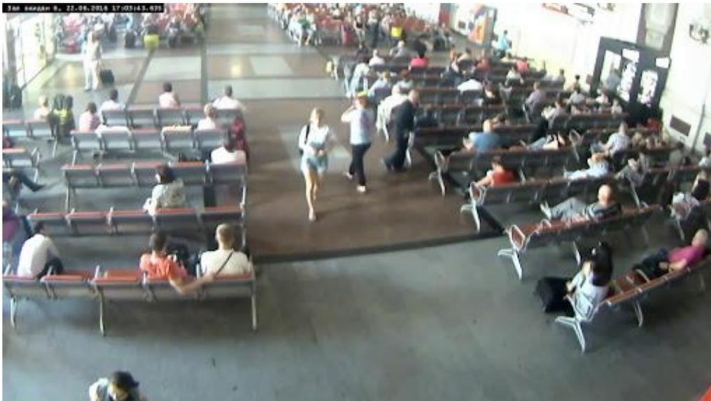
Mauvaises conditions — fortes distorsions de perspective sur une caméra grand angle entraînent l'inclinaison des personnes dans l'image (l'inclinaison d'une personne est de 22 degrés, ce qui dépasse la valeur autorisée de 20 degrés) :
