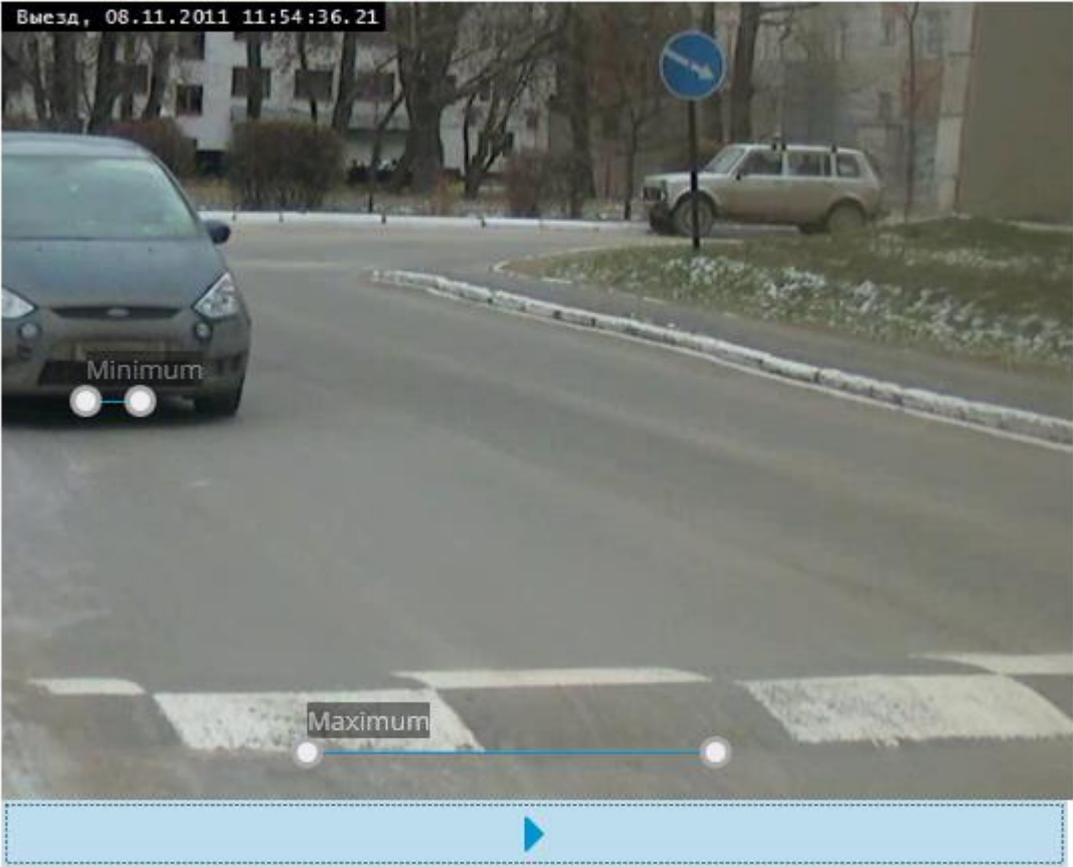
Définir les largeurs minimale et maximale de la plaque d'immatriculation. Notez que la largeur définie pour tous les modèles est importante pour le bon fonctionnement de ce module.
