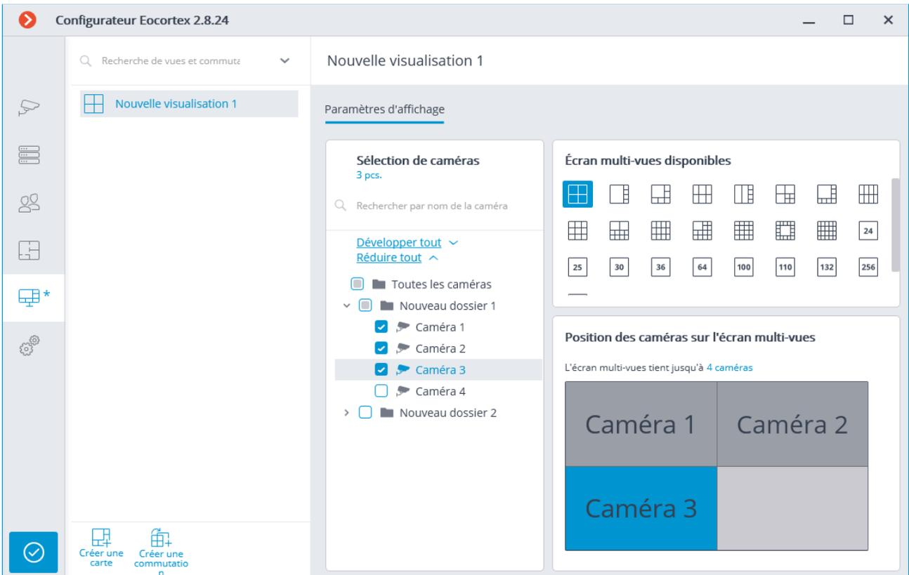
Le screenshot montre l'interface de configuration 'Configurateur Eocortex 2.8.24'. À gauche, un menu latéral contient des icônes pour la recherche, les dossiers, les utilisateurs, les vues et les commutations. Le panneau principal est divisé en sections :
