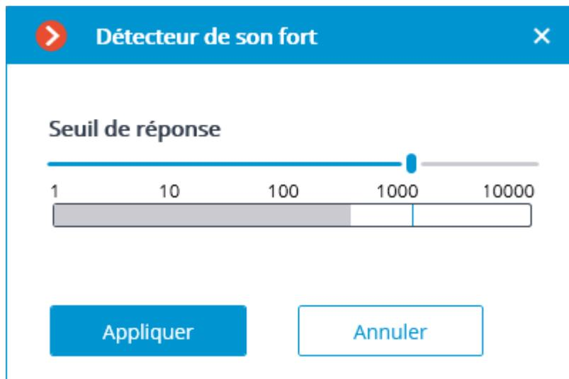
Dans la fenêtre des paramètres qui s'ouvre, l'échelle logarithmique du niveau sonore sera disponible, sur laquelle le niveau du son entrant dans le microphone de la caméra est affiché en temps réel. À l'aide du curseur **Seuil de réponse**, il faut spécifier le niveau sonore auquel le détecteur se déclenchera.
