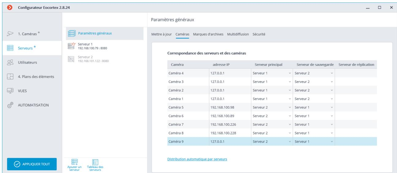
The screenshot shows the 'Configurateur Eocortex 2.8.24' interface. The left sidebar contains navigation options: '1. Caméras \*', 'Serveurs \*', 'Utilisateurs', '4. Plans des éléments', 'VUES', and 'AUTOMATISATION'. The main area is titled 'Paramètres généraux' and has sub-tabs: 'Mettre à jour', 'Caméras', 'Marques d'archives', 'Multidiffusion', and 'Sécurité'. The 'Caméras' tab is active, showing a table titled 'Correspondance des serveurs et des caméras'.
