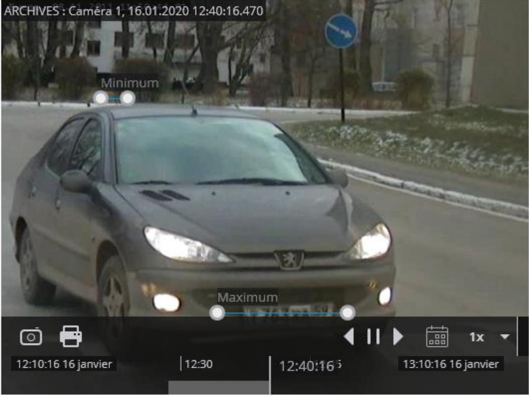
Définir les largeurs minimale et maximale de la plaque d'immatriculation. Notez que la largeur définie pour tous les modèles est importante pour le bon fonctionnement de ce module.
