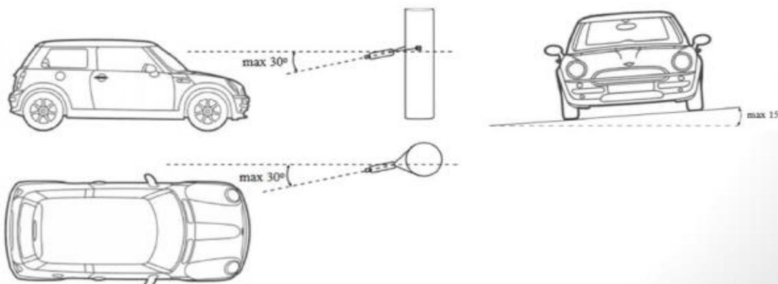
Exemples d'images des numéros à des angles de rotation et d'inclinaison acceptables et inacceptables (à titre de comparaison, le numéro supérieur sur toutes les images occupe une position de référence) :
