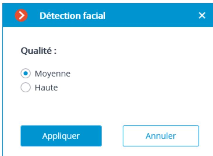
Dans la fenêtre des paramètres, il faut définir le niveau de qualité du fonctionnement du module. Ce paramètre affecte la consommation des ressources système de l'ordinateur : utilisation du processeur et de la RAM. Avec une haute qualité du fonctionnement du module, la consommation de ressources système est supérieure qu'avec la qualité moyenne.
