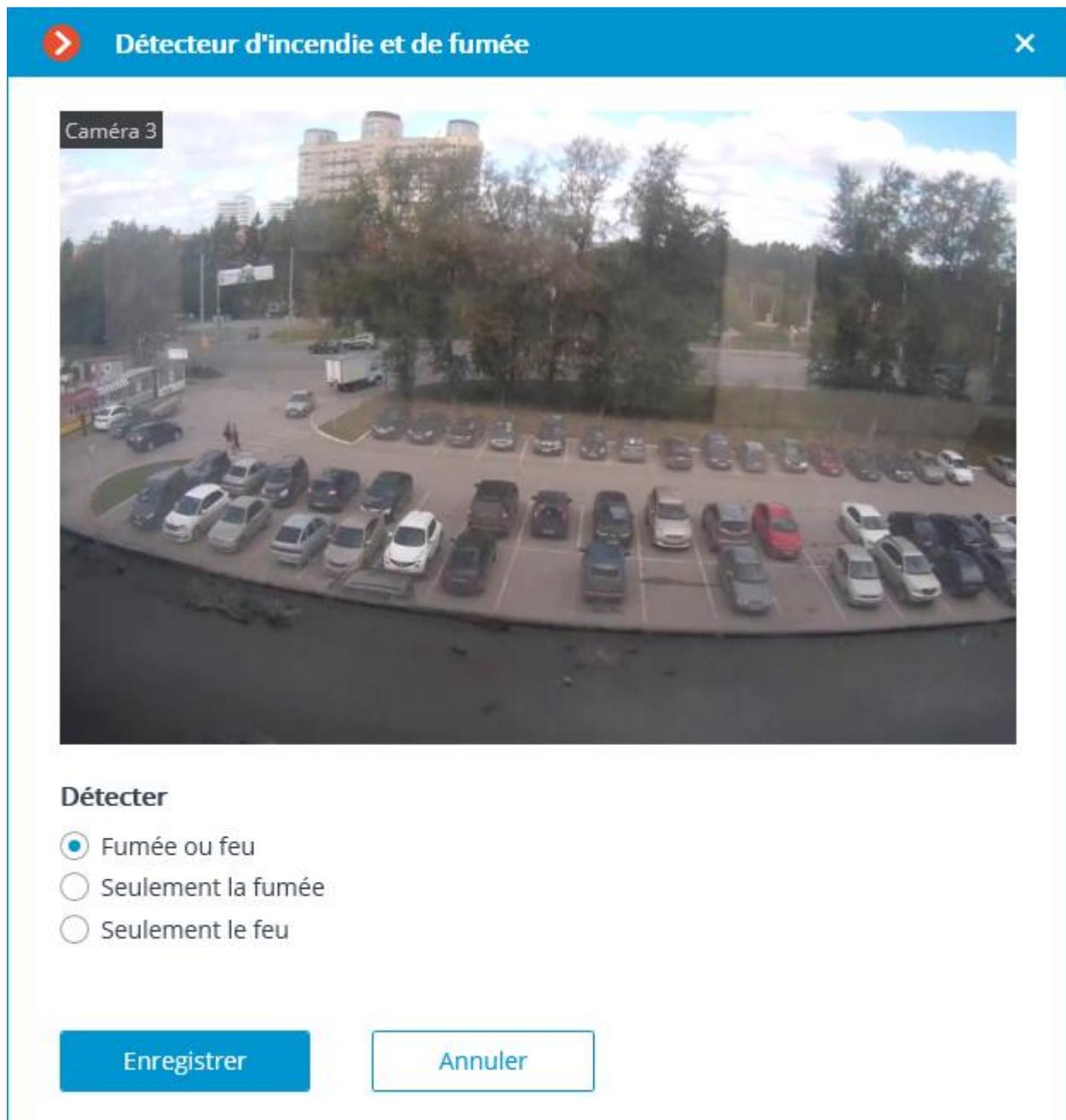
Dans la fenêtre des paramètres qui s'ouvre, il faut sélectionner l'option de détection : **Fumée ou feu**, **Seulement la fumée** или **Seulement le feu**.
